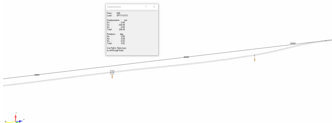
Рисунок 8 – Картина просадки трубопровода от точки врезки №1 до точки врезки №2 (ПК20-ПК22). Теплоизоляция трубопровода на участке просадочных при оттаивании ММГ
