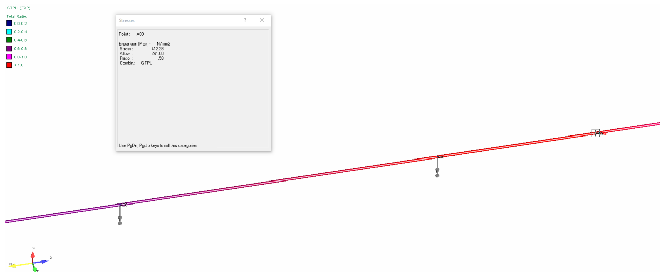
Рисунок 4 – Картина просадки трубопровода от КПЗ до точки врезки №1 (ПК30-ПК31)
