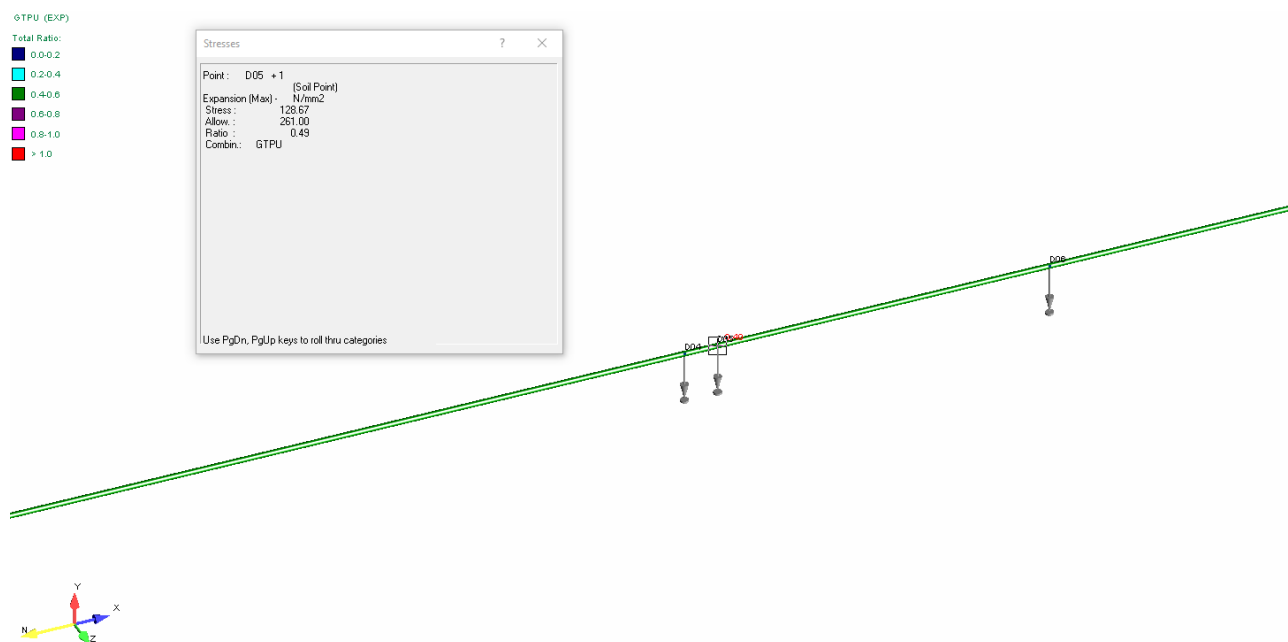
Рисунок 15 – Картина распределения напряжений по Мизесу трубопровода от КП6 до точки врезки №3 (ПК4-ПК5)
